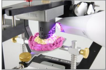
Abbildung 7: Der Scan der Bissgabel im Artikulator ermöglicht die Ausrichtung von Intraoralscans zur Scharnierachse.
